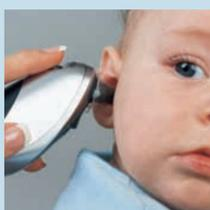
Un pitido prolongado y la luz ExacTemp iluminada de forma continua indican que se ha realizado una medición exacta. Retire la funda de sonda usada. Para la próxima medición, coloque una funda de sonda nueva y limpia.
