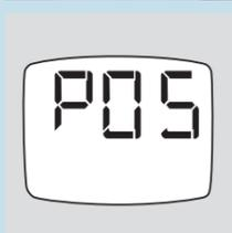
Si se coloca la sonda incorrectamente o se la desliza durante medición de la temperatura, el dispositivo emitirá un pitido, la luz verde ExacTemp se apagará y se mostrará el mensaje POS (Error de posición).
